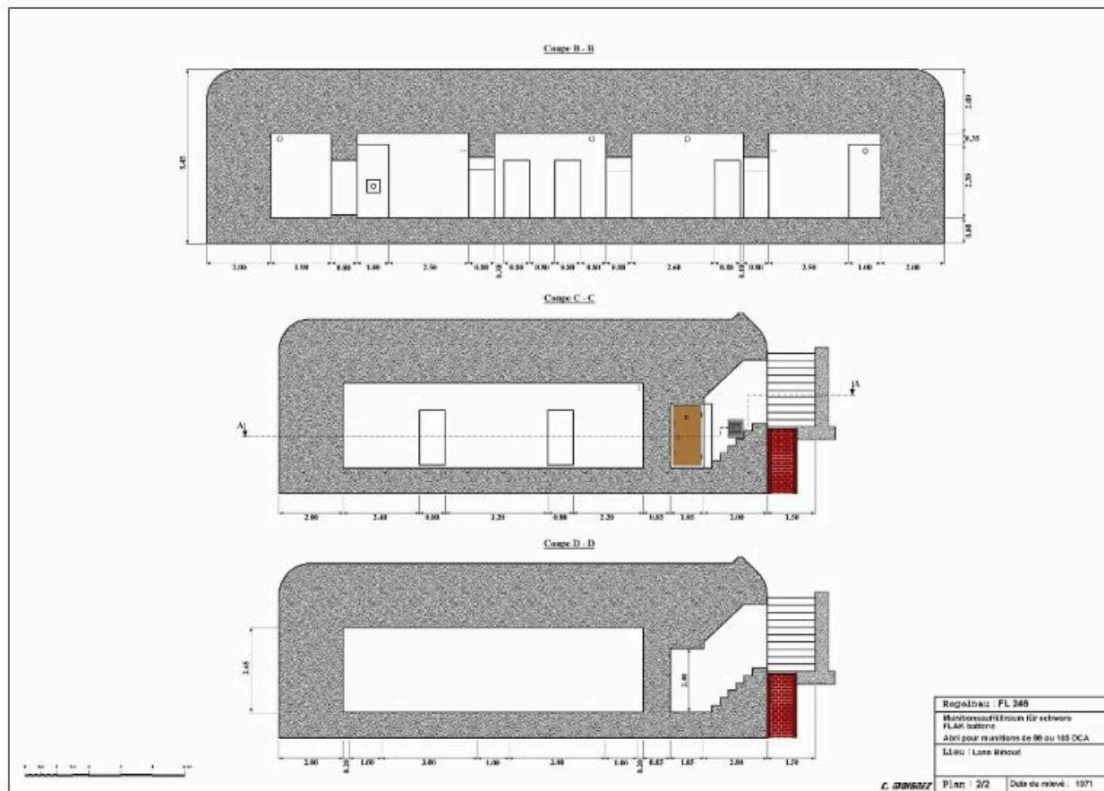
Coupes d'un bunker-magasin à munitions de type Fl 246 pour batterie antiaérienne lourde (Munitionsauffüllraum für schwere Flakbatterie). Il s'agit ici du bunker de la batterie antiaérienne de Moustoir Flamm (Lo 305) à Quéven près de Lann Bihoué
