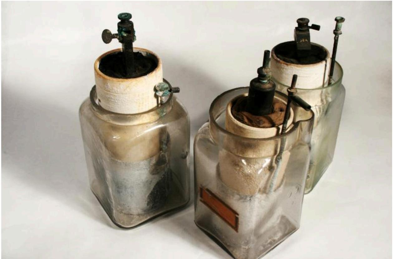
Pile de Leclanché et Eléments de la pile de Bunsen ou de la pile à charbon - Electricité dynamique (Non signé)
