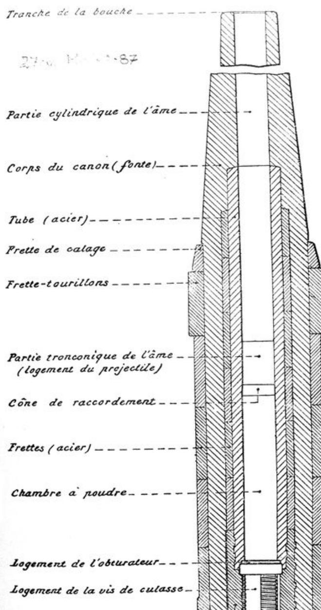
Coupe d'un canon de 27 cm modèle 1870-1887 (armement des batteries de Kerviniou et de la pointe des Espagnols sur affûts M modèle 1888 PC)
