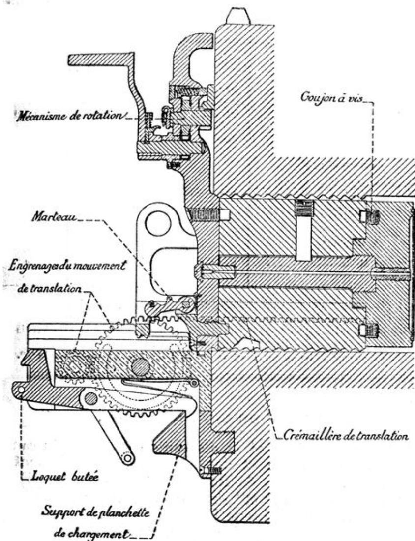
Fig. 74. — Mécanisme de culasse du canon de 32<sup>e</sup> m,
