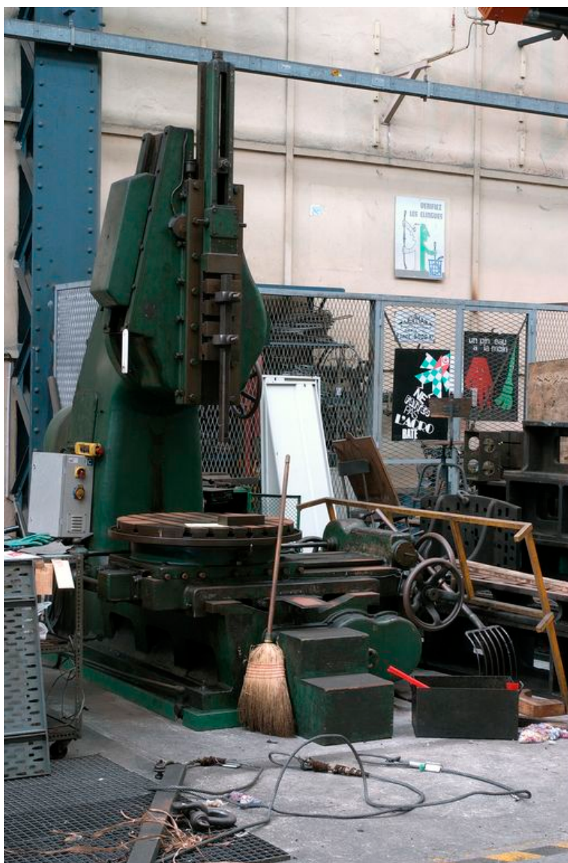
Vue de la halle d'usinage : machine à mortaiser Somua (1946)
