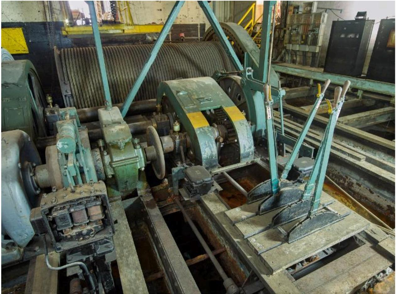
Vue d'une résistance (rhéostat ?) (à gauche) et des commandes mécaniques du treuil par levier (à droite)
