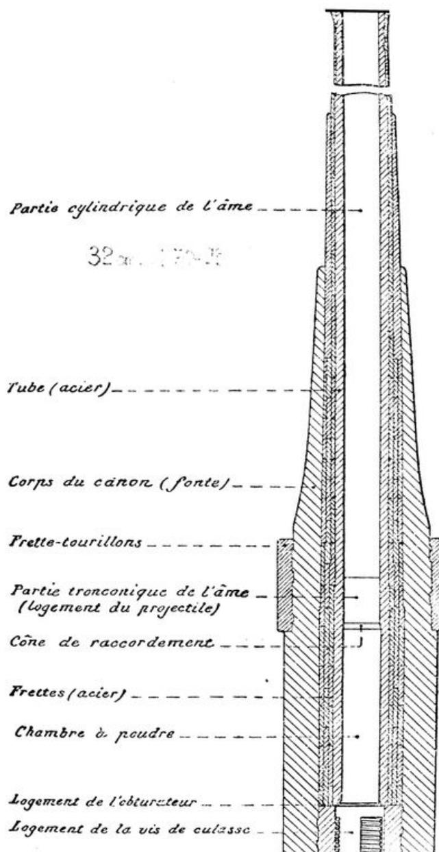
Coupe d'un canon de 32 cm modèle 1870-1893 (armement des batteries du Minou et des Capucins sur affûts M modèle 1882 PA)
