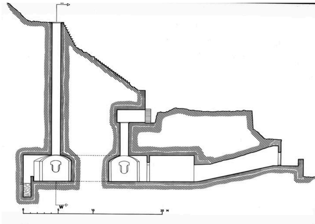
Coupe longitudinale de la batterie de rupture sous roc de Cornouaille
