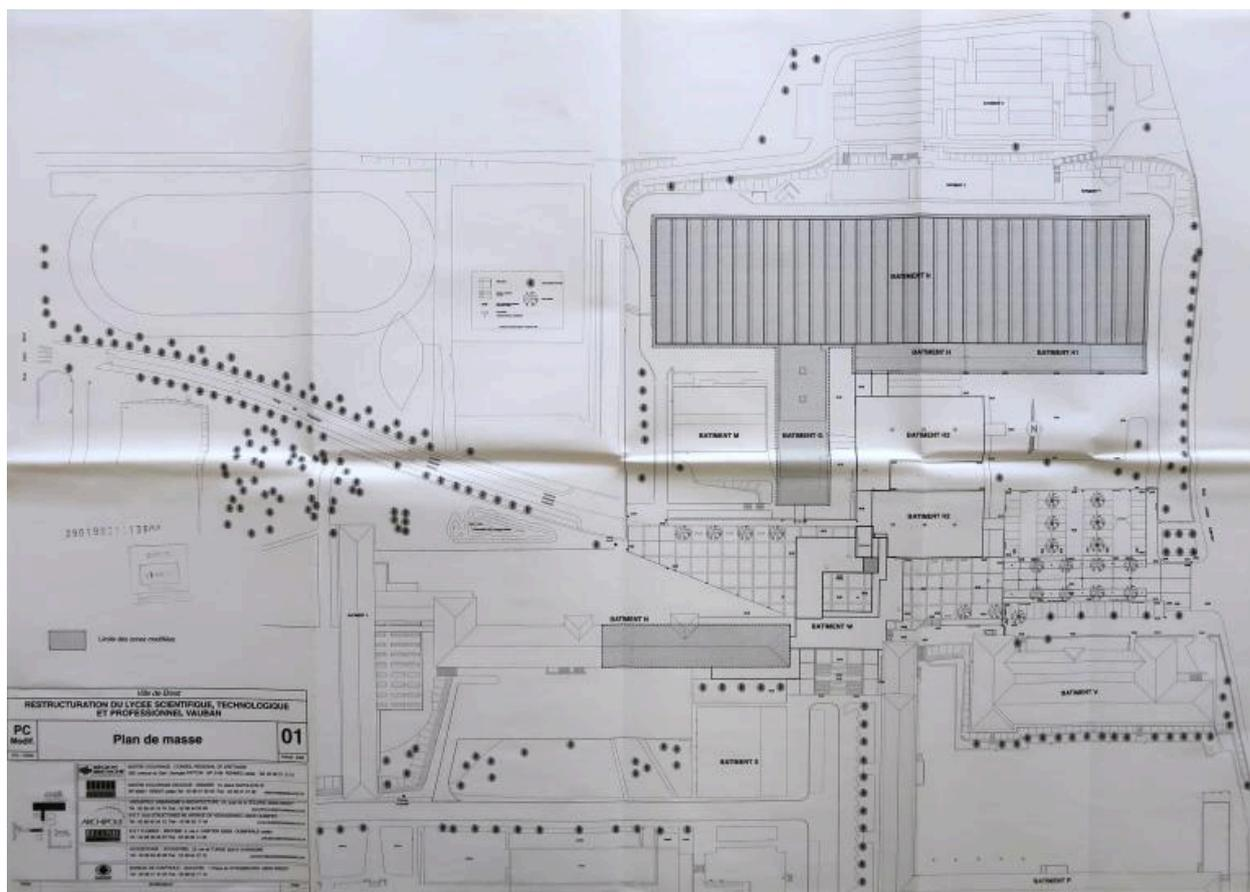
Plan de masse, Archipôle UA, architectes, (plan modifié en 2006). En grisé, les bâtiments restructurés. Les bâtiments W et H2 sont des constructions neuves.
