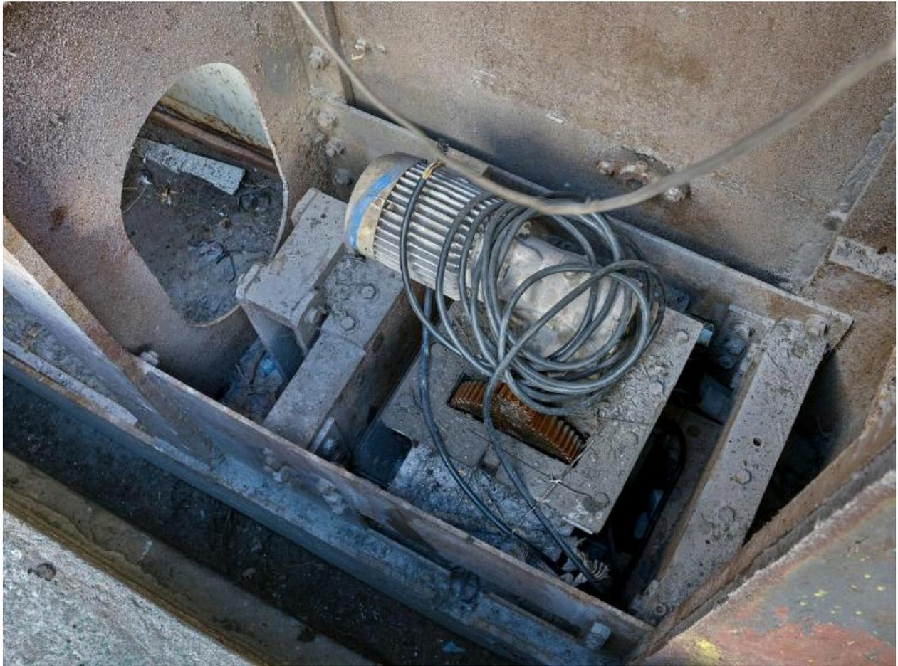
Vue intérieure de l'un des deux volets de la porte blindée nord : système motorisé permettant l'ouverture de la porte
