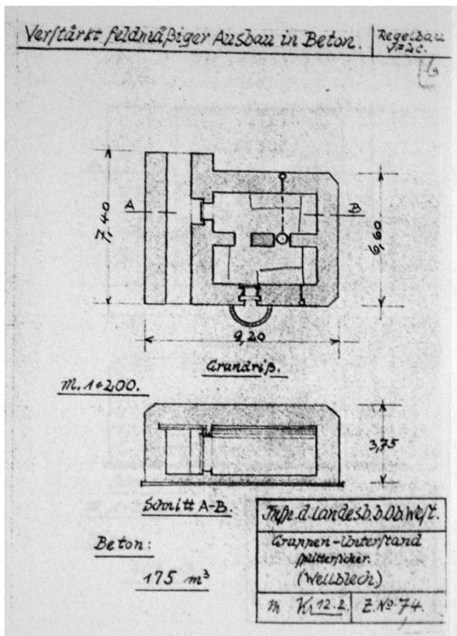
Plan d'un bunker - casemate de type VF 2c (Verstärkt feldmäßiger Ausbau in Beton, Regelbau VF2c : Gruppen-Unterstand bis 12 Mann, Splittersicher [pare-éclats], Wellblech [tôle ondulée])
