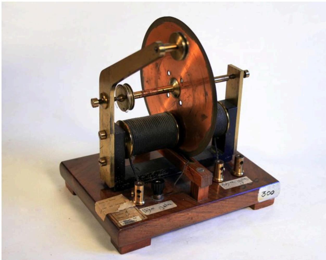
Disque de Foucault - Electricité dynamique (Radiguet & Massiot)
