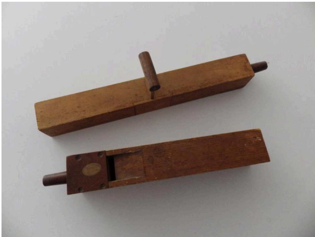
Tube sonore à bouche à coulisse et modèle d'embouchure de flûte - Acoustique-Vibration (Non signé)
