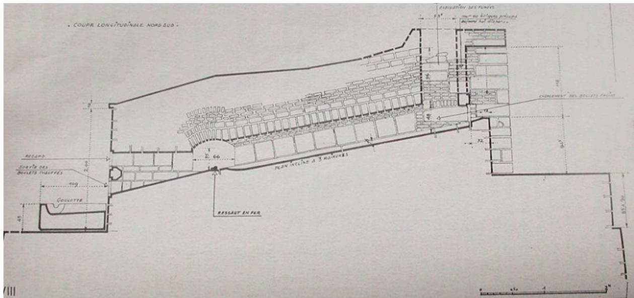
Coupe longitudinale du four à boulets d'Erquy par Lestienne Brevet, 1951
