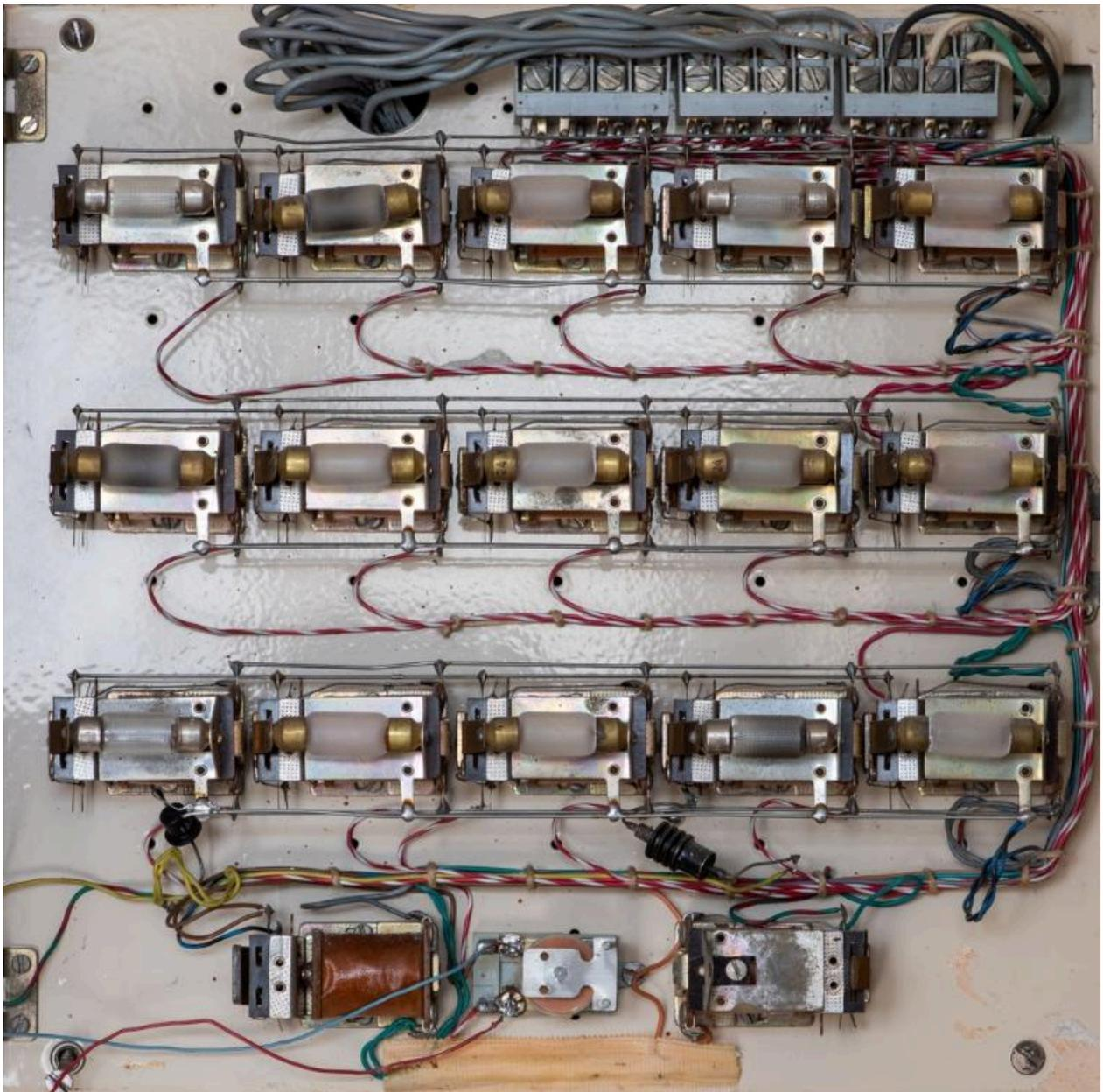
Système d'appel d'urgence pour 15 chambres : détail du mécanisme.
