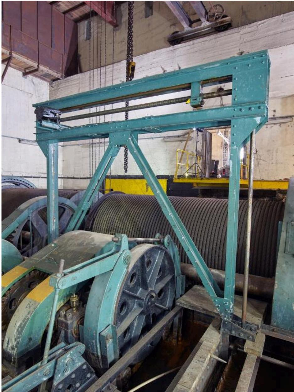
Vue du système à vis permettant de suivre le déroulement et l'enroulement des câbles du treuil
