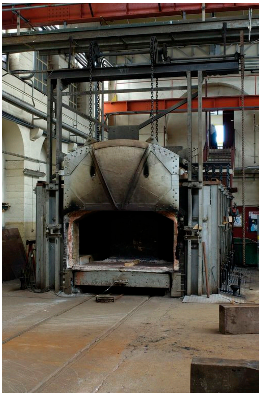
Vue de la halle de chaudronnage : four Jaubé antérieur à 1940
