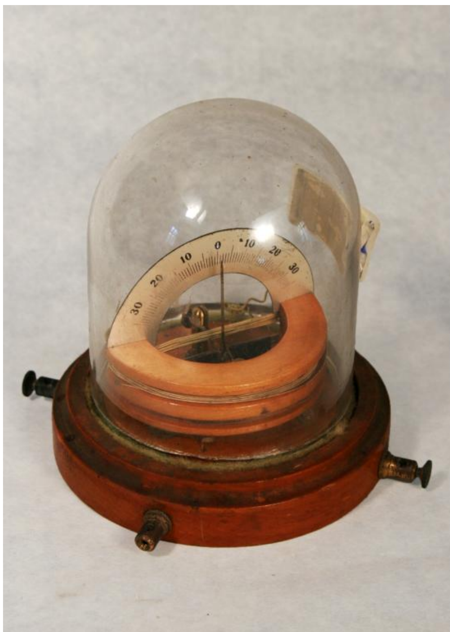
Boussole-galvanomètre différentiel - Electricité dynamique (Non signé)
