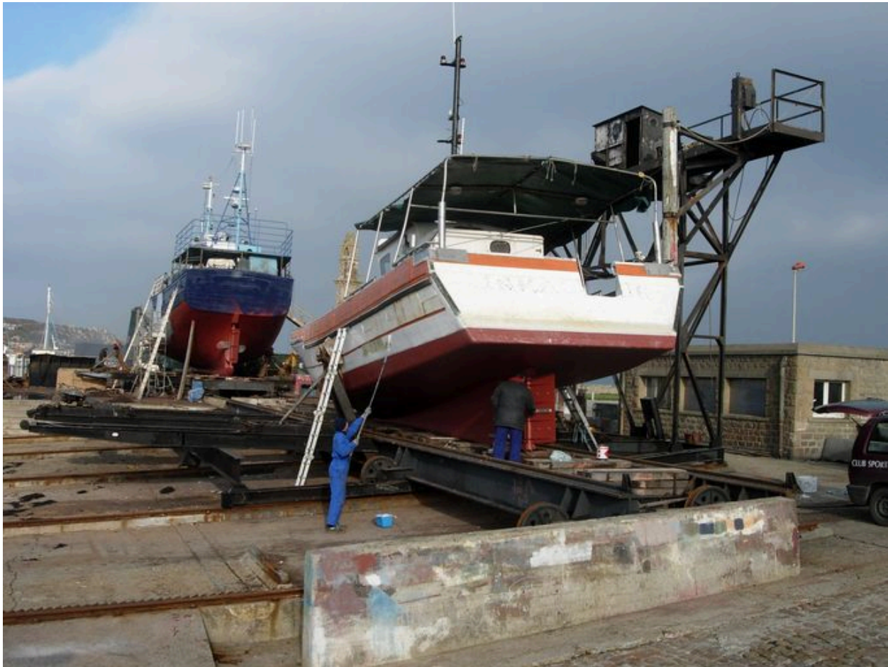
Slipway de Camaret avec chariot à bateau
