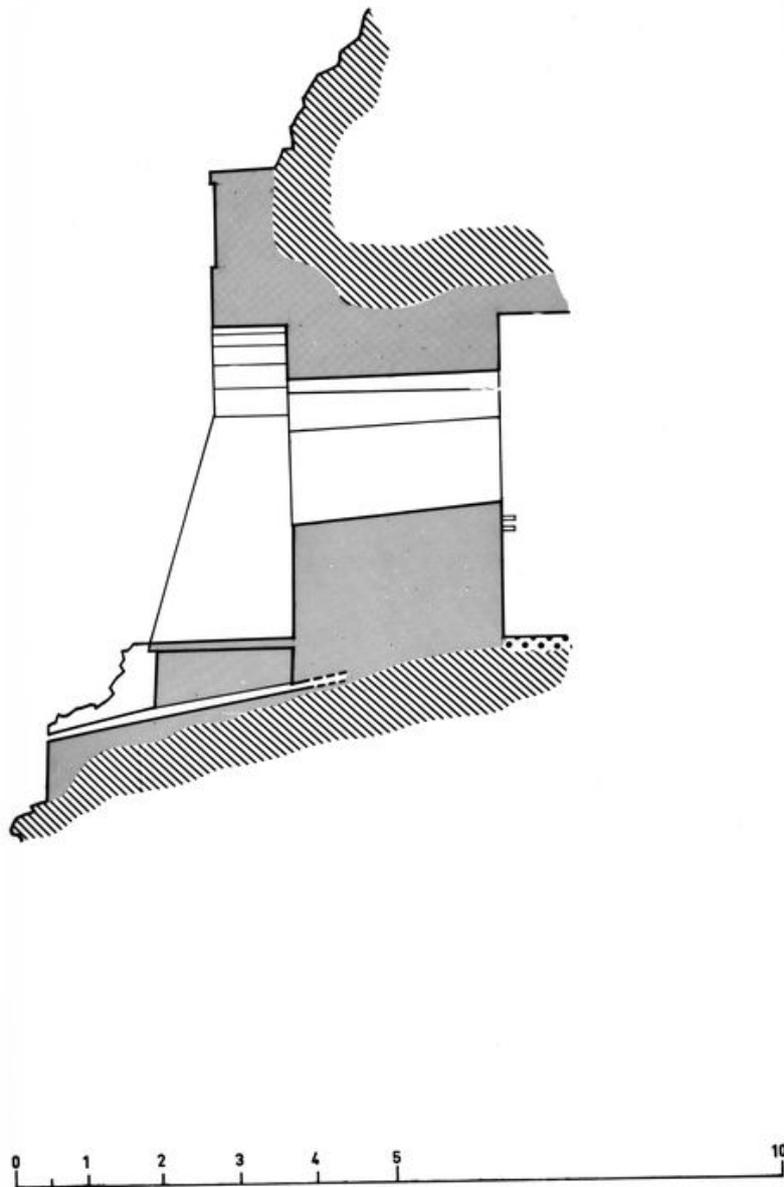
Coupe de l'une des deux embrasures de la batterie de rupture de l'îlot des Capucins
