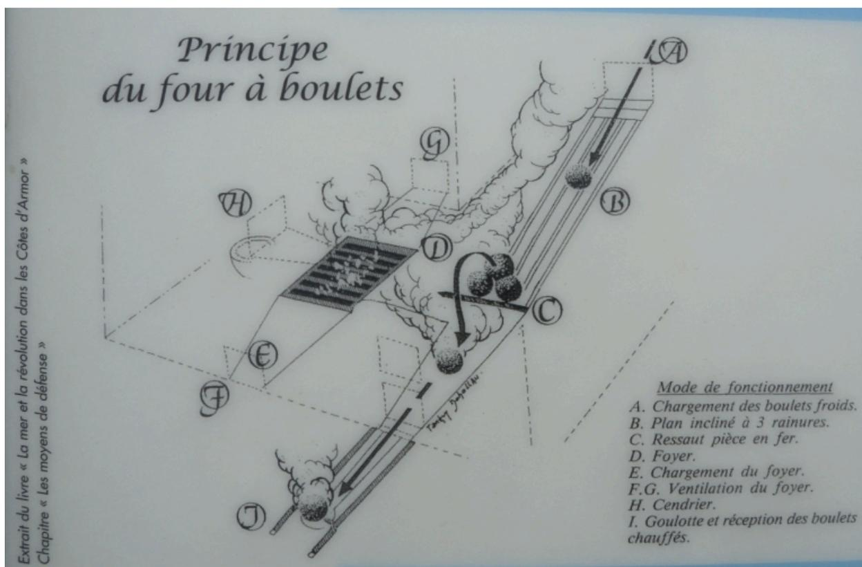
Principe de fonctionnement du four à boulets (extrait de la signalétique en place d'après Guy de Sallier Dupin)
