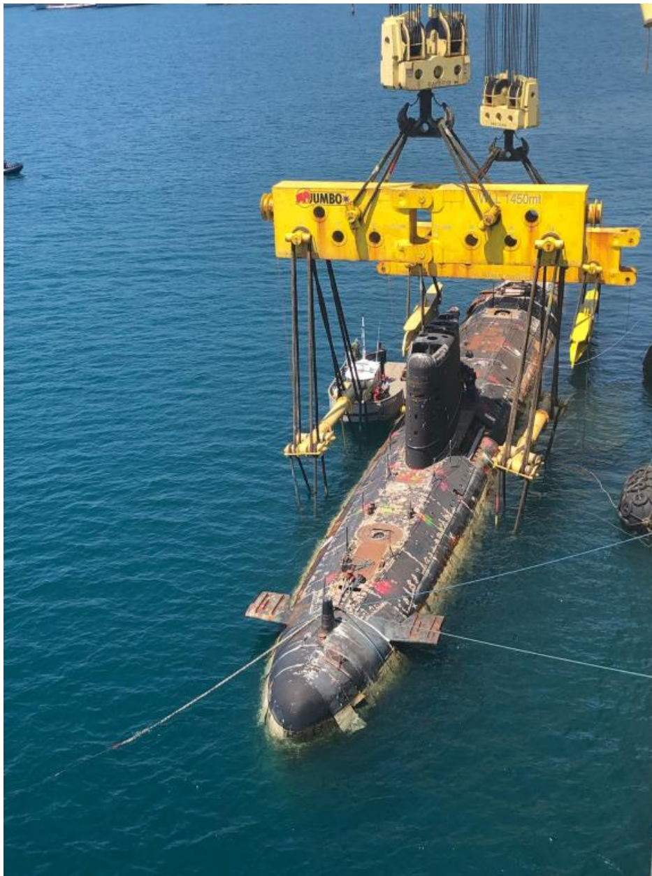
Chargement de la coque de l'Agosta sur le pont du Jumbo Kinetic en rade de Toulon, 29 juillet 2021
