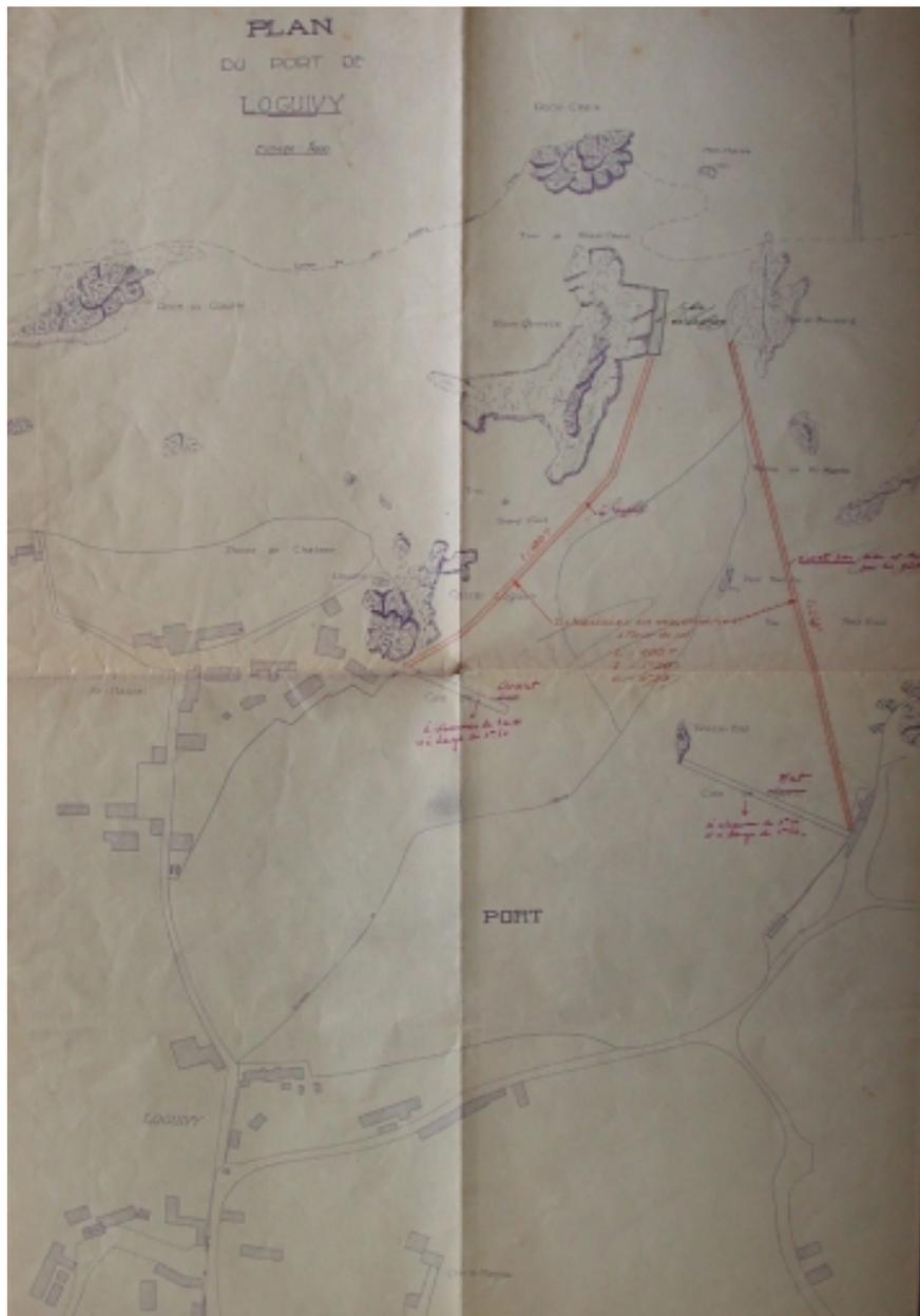
Plan daté de 1951 : projet d'élargissement et d'exhaussement des 2 cales et de réalisation d'un chemin surélevé entre le Castel et Roc'h Quionce (AD 22)
