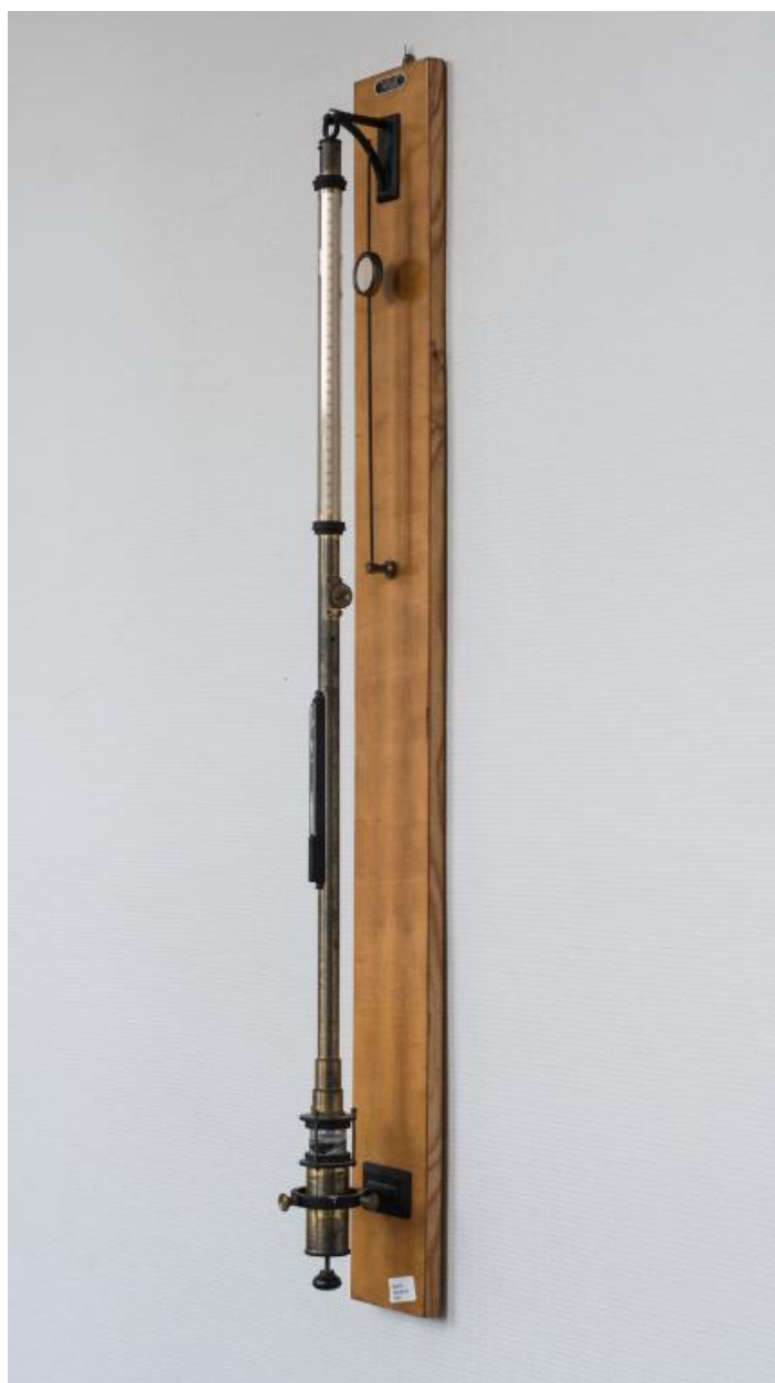
Baromètre de Fortin - Propriétés des gaz (Lehalle)
