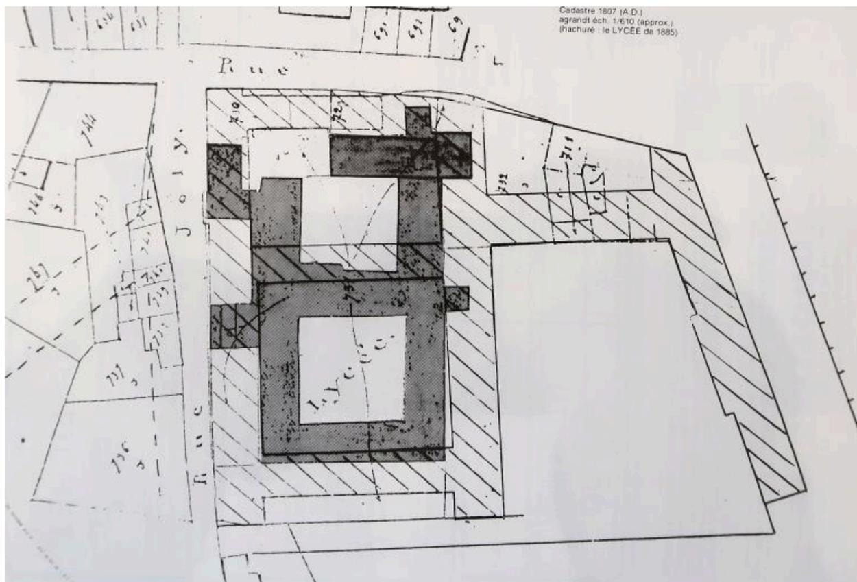
Superposition des plans du lycée avant restructuration (ancien couvent des Ursulines) et après restructuration (années 1885-91).
