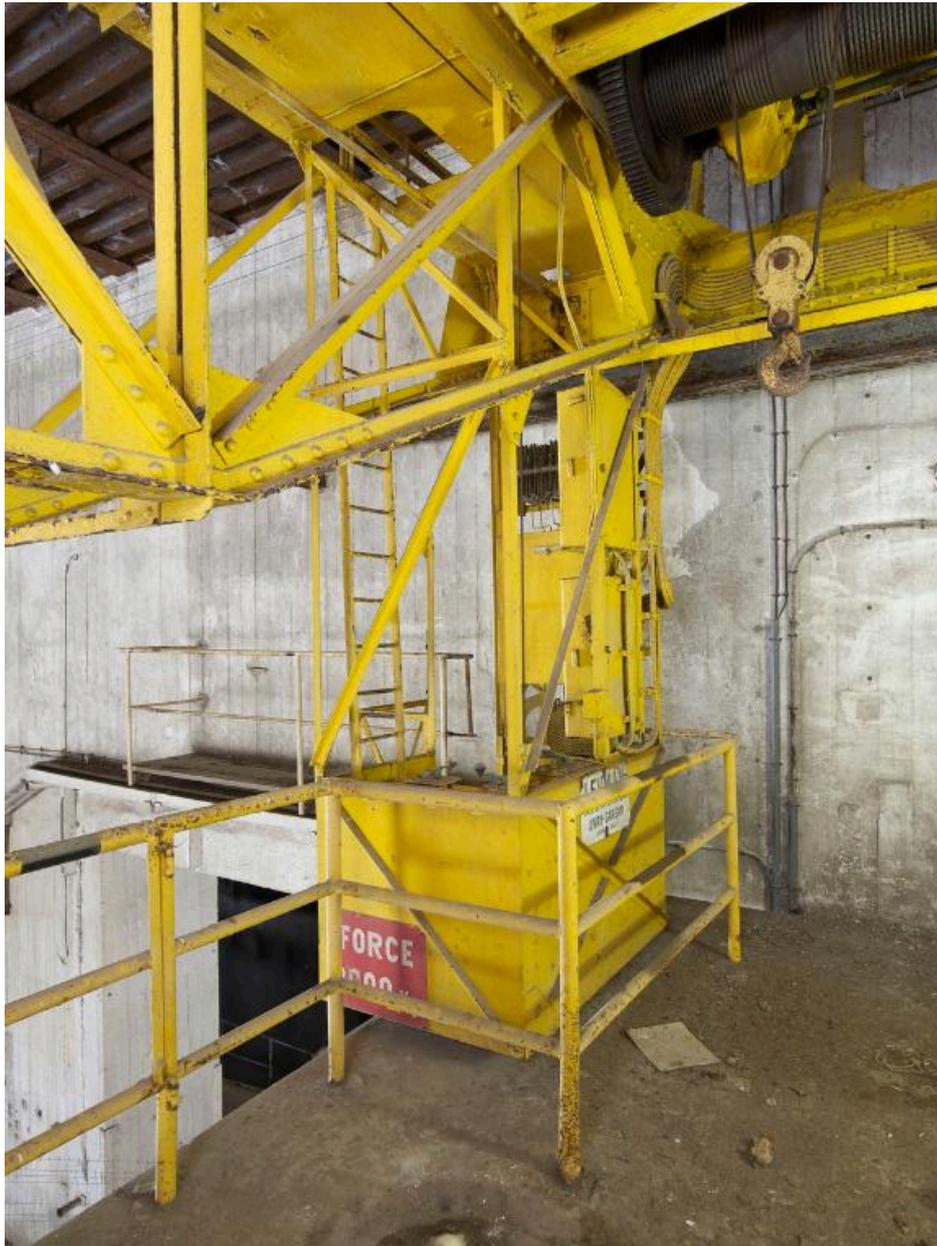
Vue du pont roulant d'une capacité de 2 t de l'alvéole sud (état en 2023). Il est arrêté au-dessus de l'avancée du premier étage
