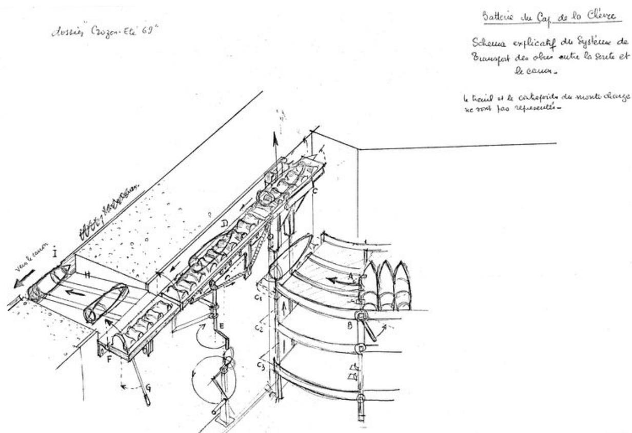
Schéma explicatif du système de transport des obus entre la soute et le canon (Le treuil et le contre poids du monte-charge ne sont pas représentés)
