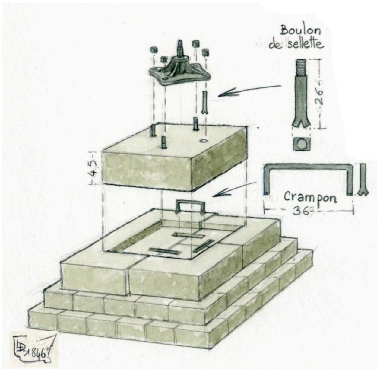
Evocation du massif d'ancrage en maçonnerie d'une plate-forme d'artillerie de côte, par Lionel Duigou.
