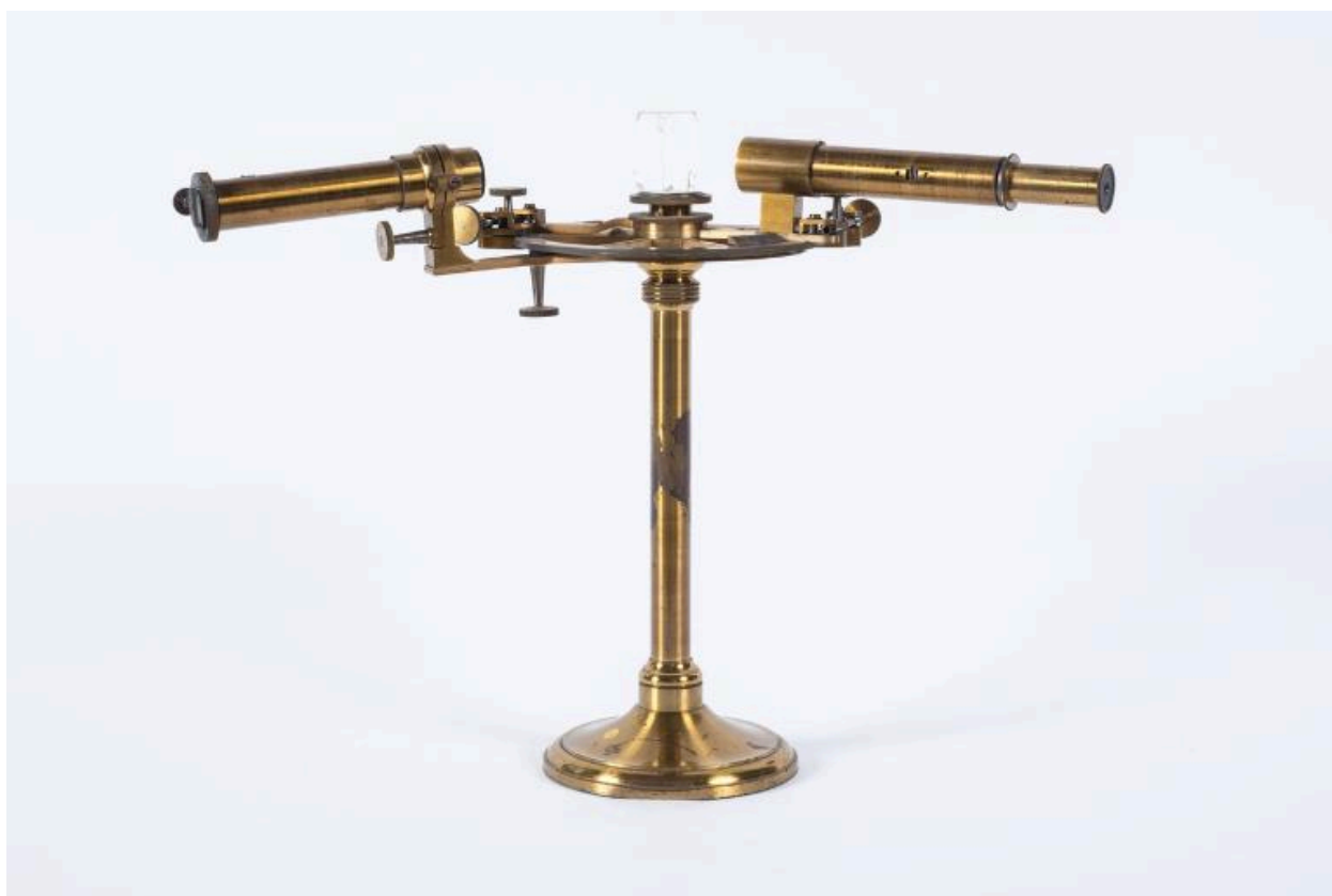
Goniomètre de Babinet - Optique-Géodésie (J. Duboscq, c. 1880)
