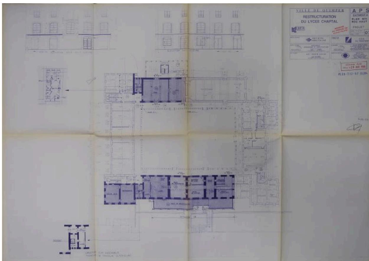
Plan du rez-de-chaussée haut. restructuration du lycée Chaptal. Archipôle urbanisme et architecture, 1999. Noter notamment l'extension et la réorganisation du CDI. Ce plan et celui du niveau 1 sont en annexes PDF à ce dossier.
