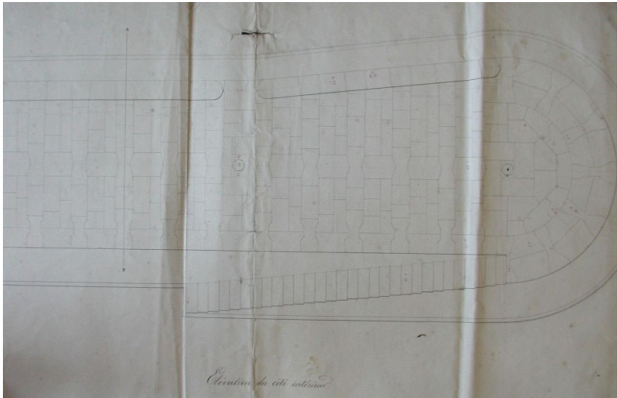
Plan détail appareil du musoir : élévation du côté intérieur de la jetée du Linkin, 1852 (AD 22)
