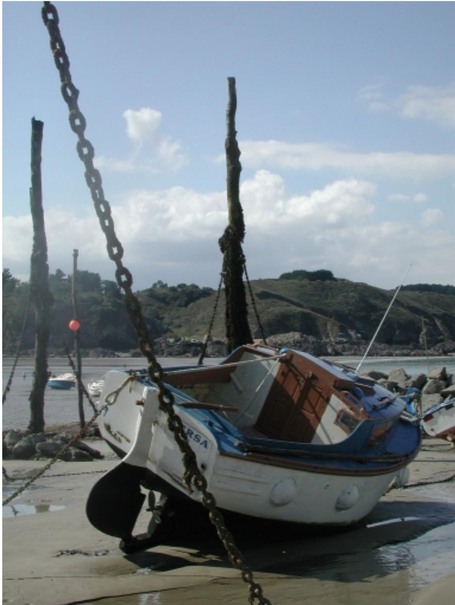
Amarrage d'un bateau, avant-arrière, entre deux pieux parallèles, afin de limiter le rayon d'évitage
