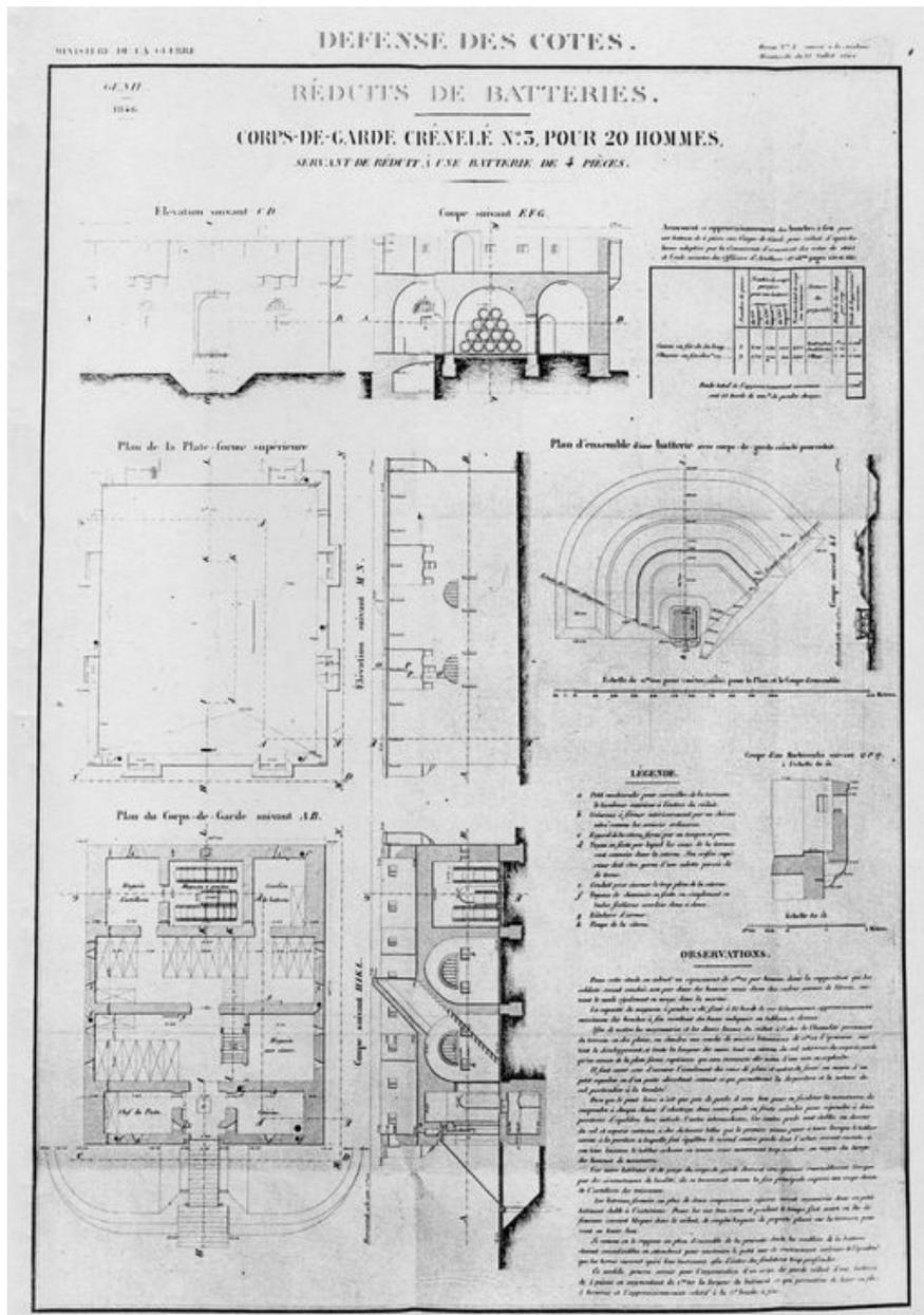
Plans, coupes, et élévations des réduits de batteries : corps de garde crénelé n° 3 pour 20 hommes servant de réduit à une batterie de 4 pièces, 1846
