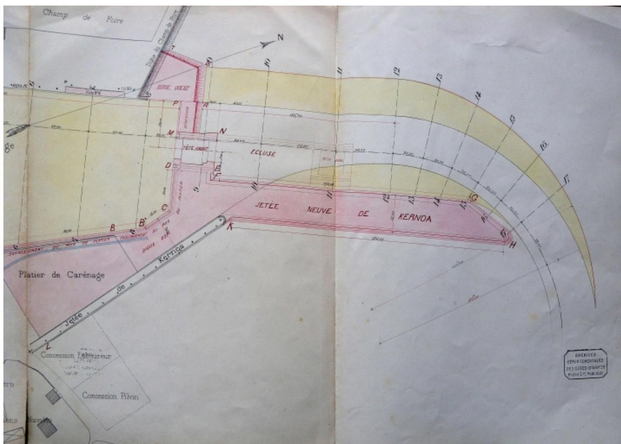
Plan du port de Paimpol en 1893, projet d'agrandissement du bassin à flot, l'écluse de l'avant-port devant la jetée de Kerno (AD 22)
