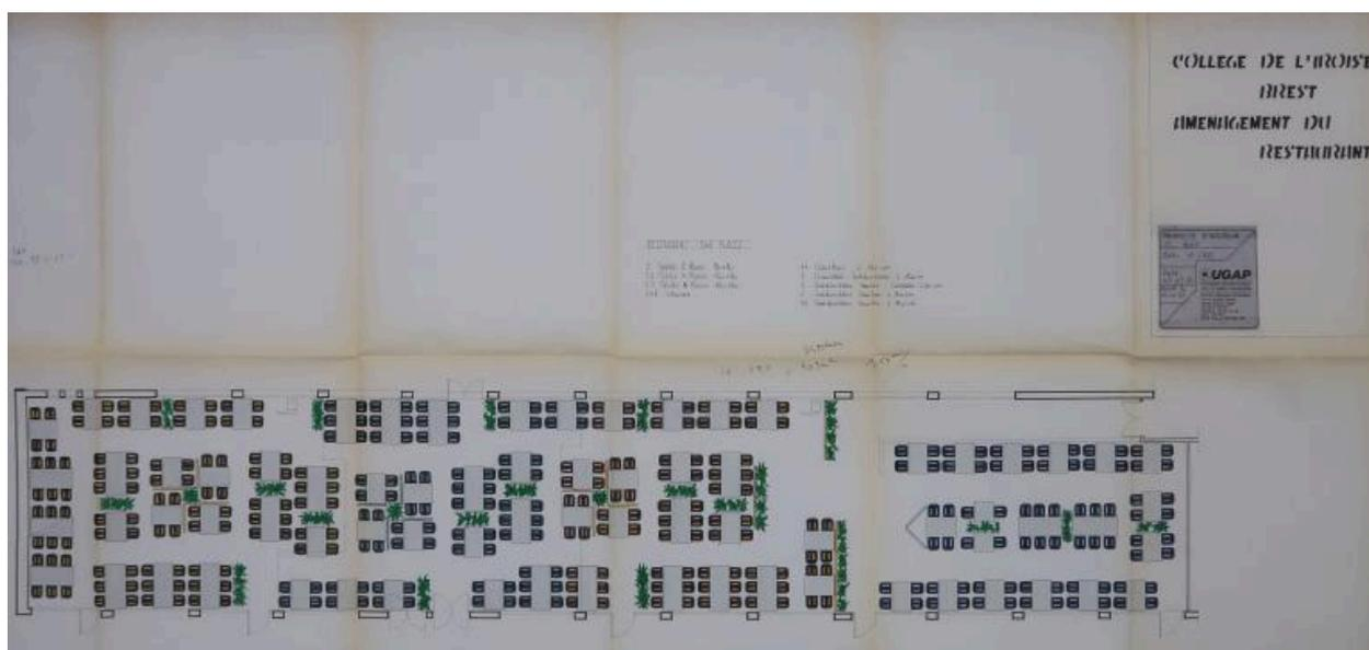
Réaménagement du réfectoire, en 1993. La transformation en self-service permet de supprimer le couloir de desserte situé à l'est (en haut sur ce plan). Les cloisons entre les salles sont remplacées par des claustras et des jardinières.
