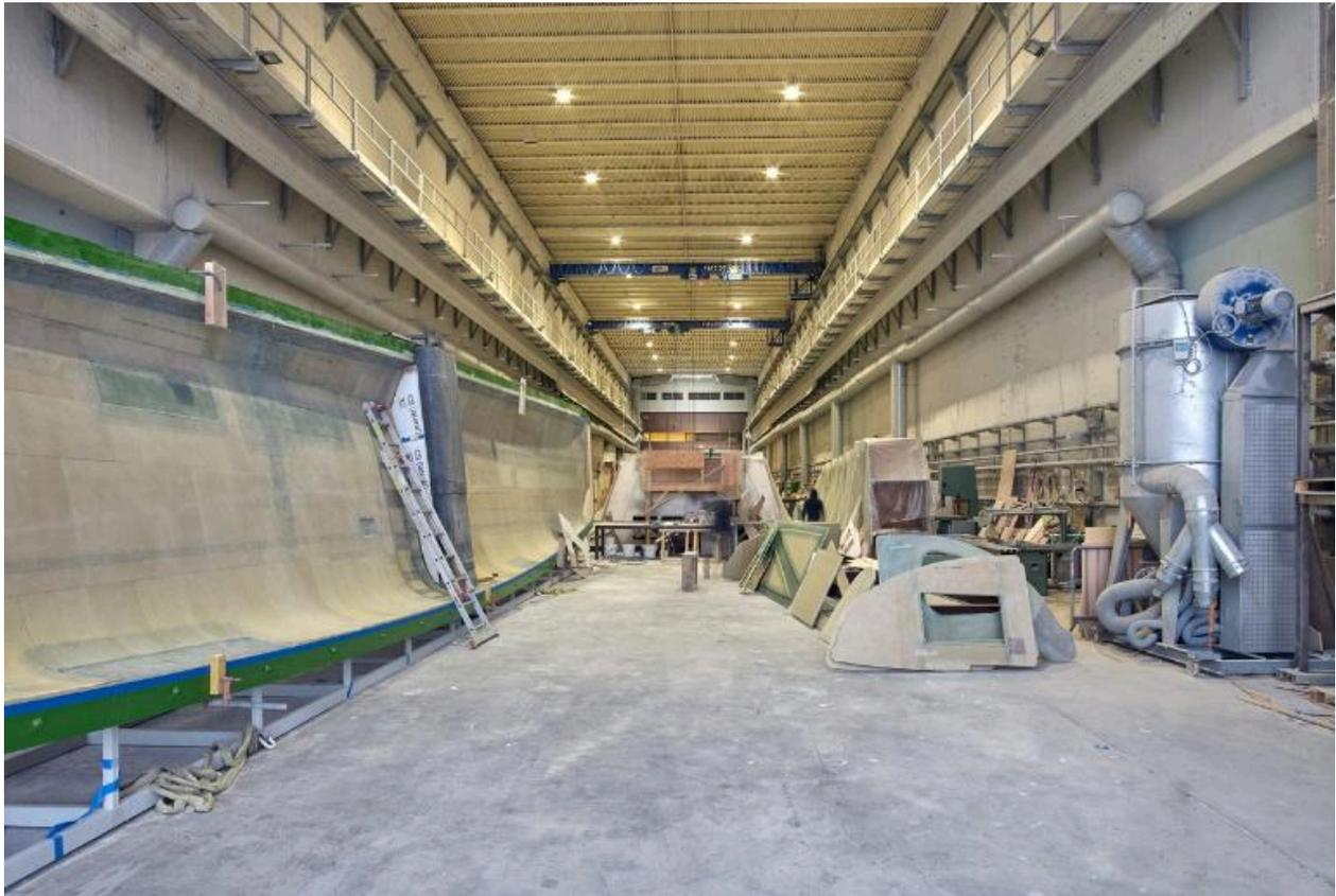
Vue générale de la nef n° 1 depuis l'extrémité nord (le tirant d'air est de 15 m). Elle est dotée de deux ponts roulants. De part et d'autre de la nef se trouvent des passerelles. La nef abrite le chantier naval Marsaudon Composites
