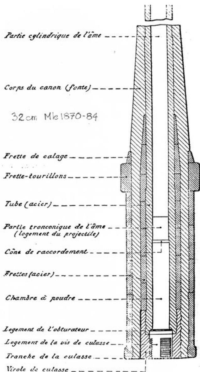
Fig. 19. — Canon de 32<sup>m</sup>, M<sup>le</sup> 1870-84, de 48,200 kilogr.
