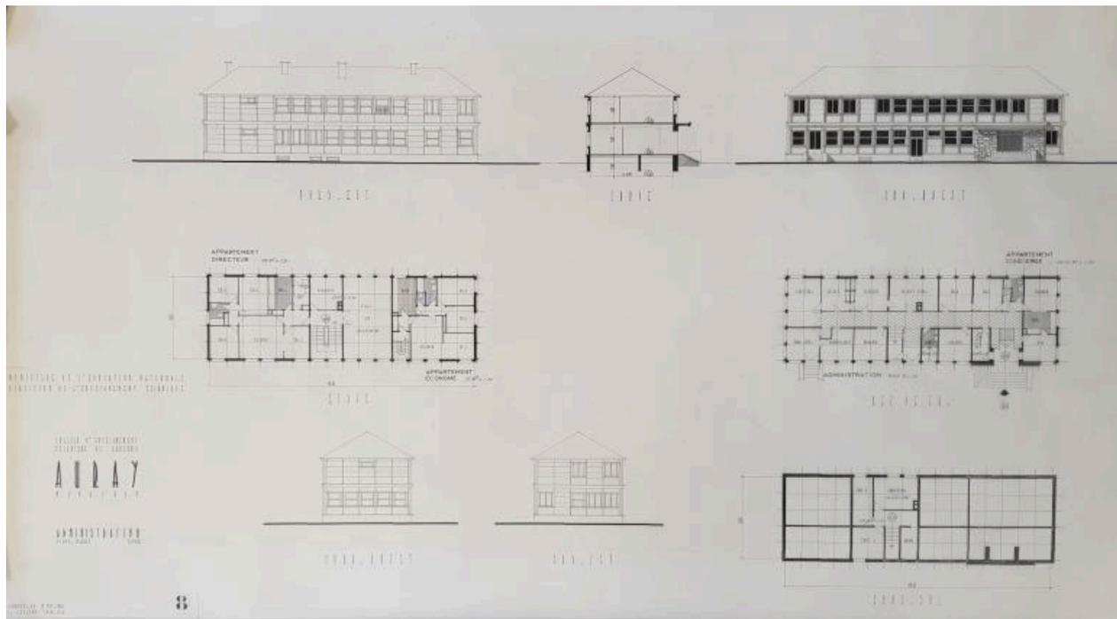
Plans et élévations de l'administration (Yves Guillou architecte, 1961). Le plan en bas à droite montre que ce bâtiment-là, aussi, est composé sur une trame de 1,75 m.
