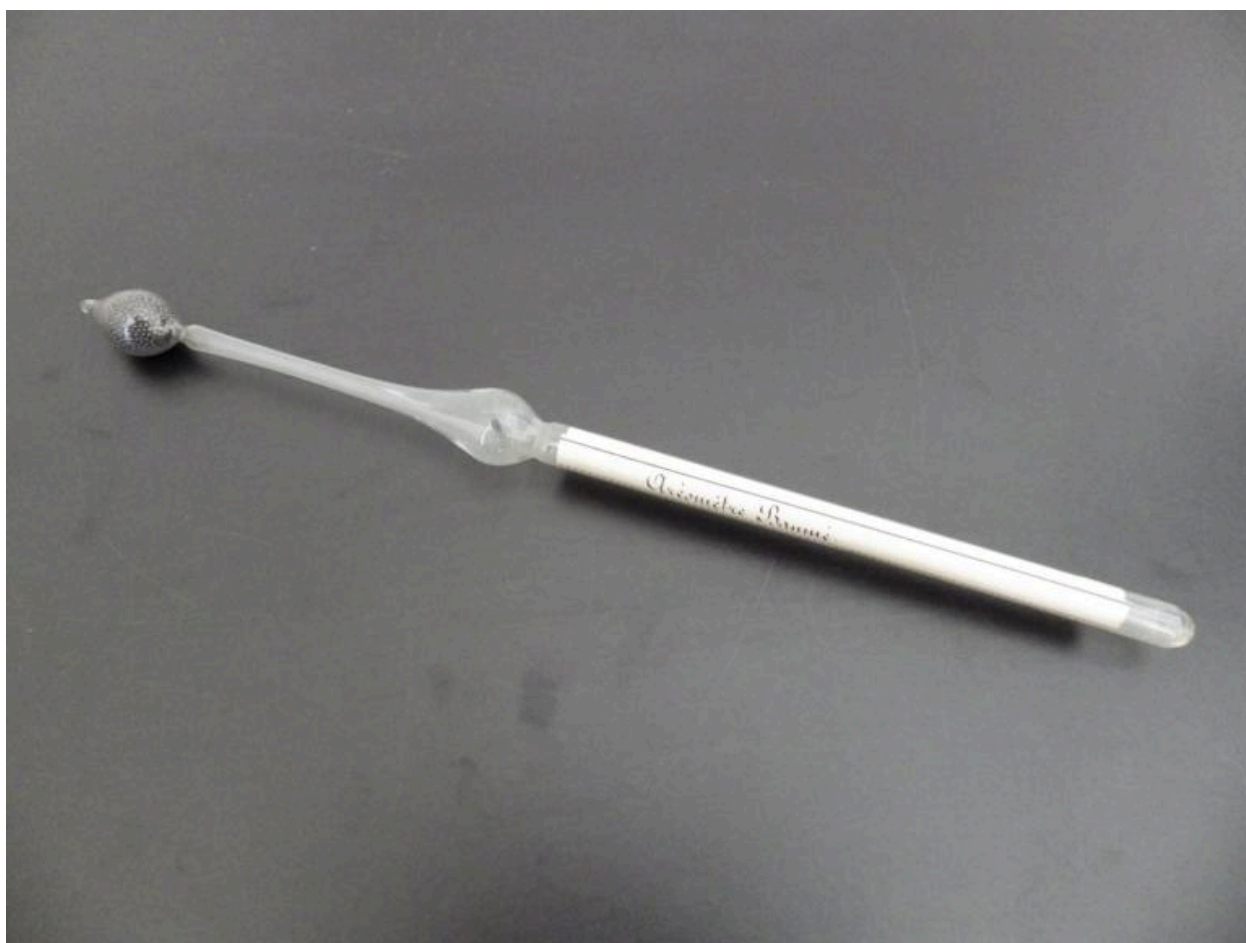
Aréomètre Baumé - Hydrostatique-Hydrodynamique (Non signé)
