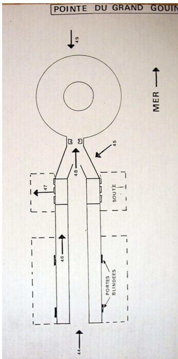
Plan schématique de l'une des quatre cuves pour canon Schneider de 22 cm de la batterie du Grand Gouin, annexe extraite du rapport Pinczon du Sel
