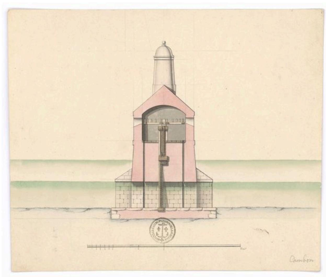
Coupe d'une des trois portes d'écluse destinées à l'alimentation d'un fossé en eau du fort projeté sur la hauteur de la batterie de Cornouaille à l'entrée du Goulet de Brest. 1684 (?), auteur inconnu mais supervisé par Vauban
