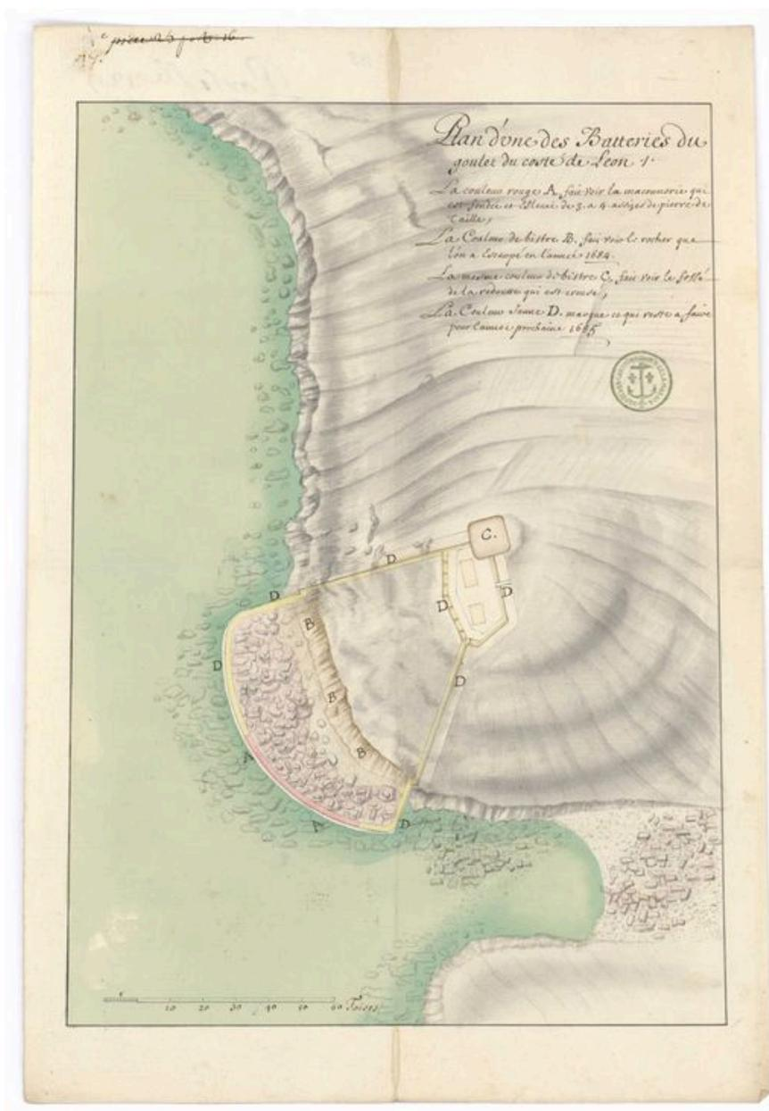
Plan de la batterie de Léon, fait à Brest en 1684 par Mollart. Plan général : travaux exécutés en 1684, projets pour 1685
