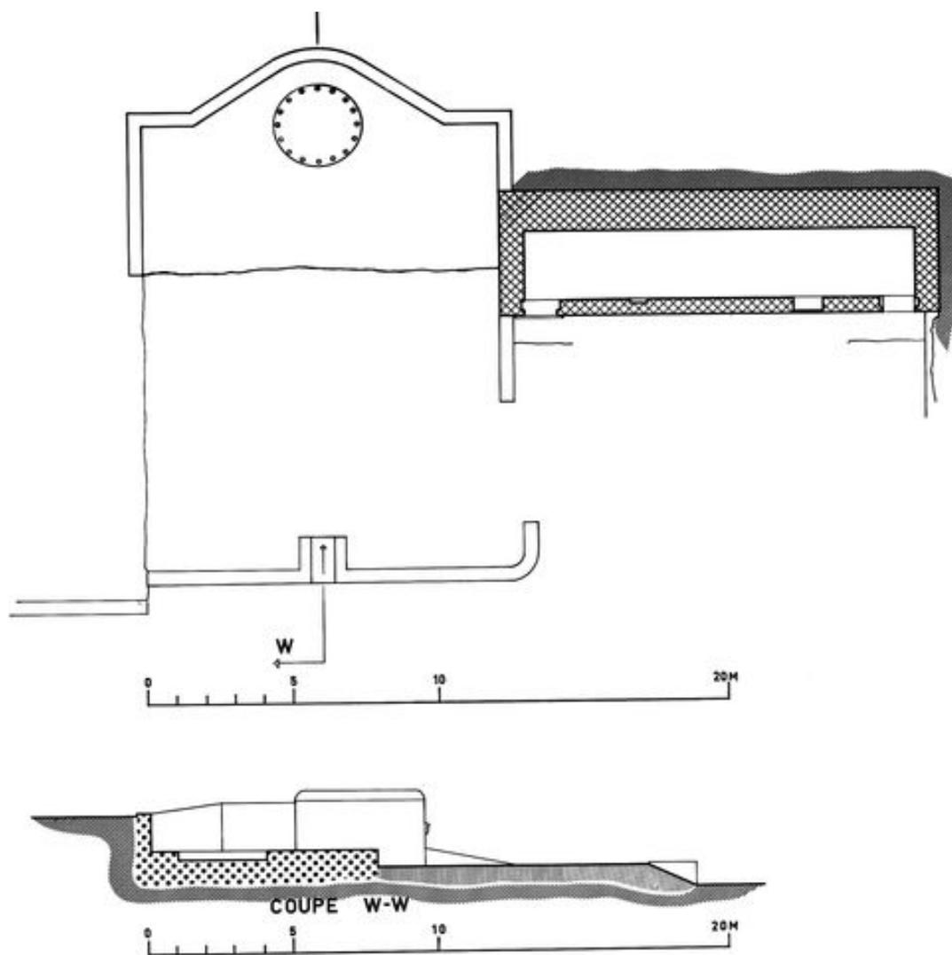
Plan et coupe WW d'une plate-forme de pièce et de son alvéole (localisation approximative : batteries des Capucins)
