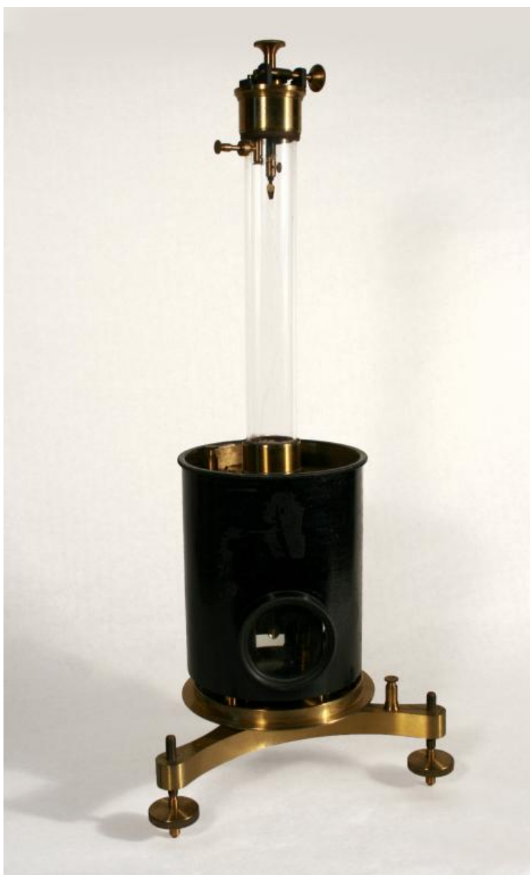
Electromètre à quadrants de Mascart – Electricité statique (Non signé)
