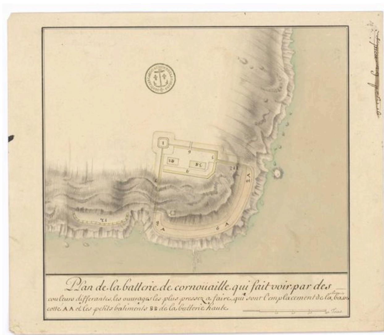
Plan du projet de la batterie de Cornouaille (escarpement, projet de branches tombantes, de batterie haute et de tour-réduit) et de Beaufort pour montrer les ouvrages les plus pressés à faire, 1684 (?) par Mollart
