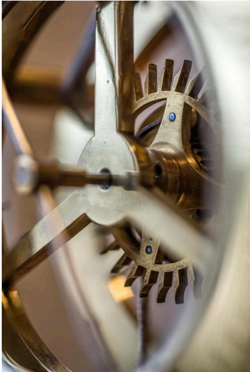
Mécanisme de l'échappement à ancre du compte-seconde
