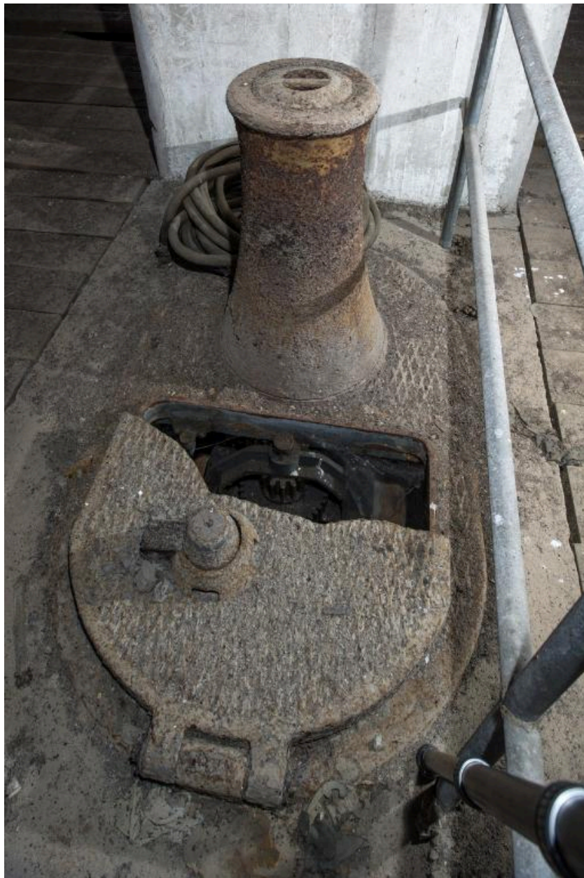
Vue de l'un des cabestans électriques à commande à pédale (marqués au nom de l'établissement Hillairet Paris Persan)
