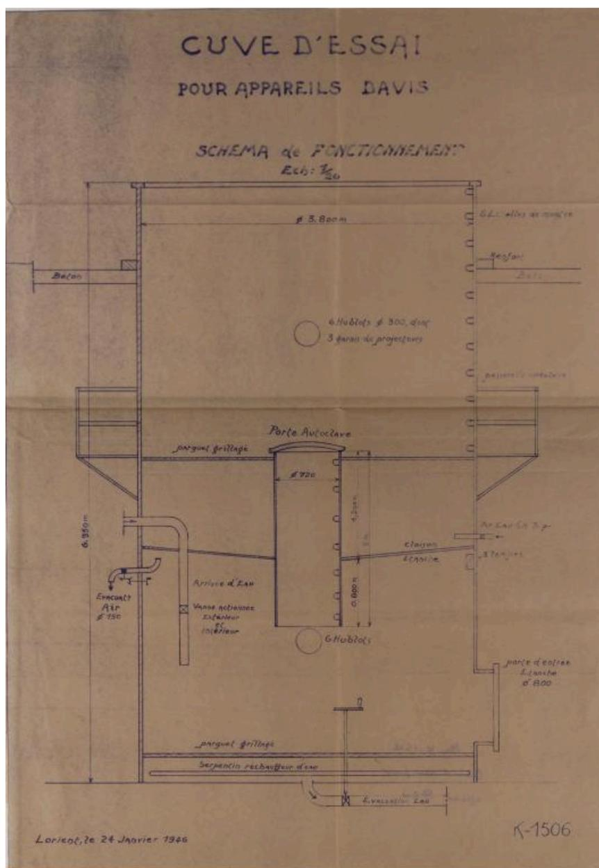
Schéma de fonctionnement de la cuve d'essai pour appareils Davis, plan K n° 1506, 24 janvier 1946 (Service Historique de la Défense de Lorient, Monographie de la base Ingénieur Général Stoskopf, 1945-1946)
