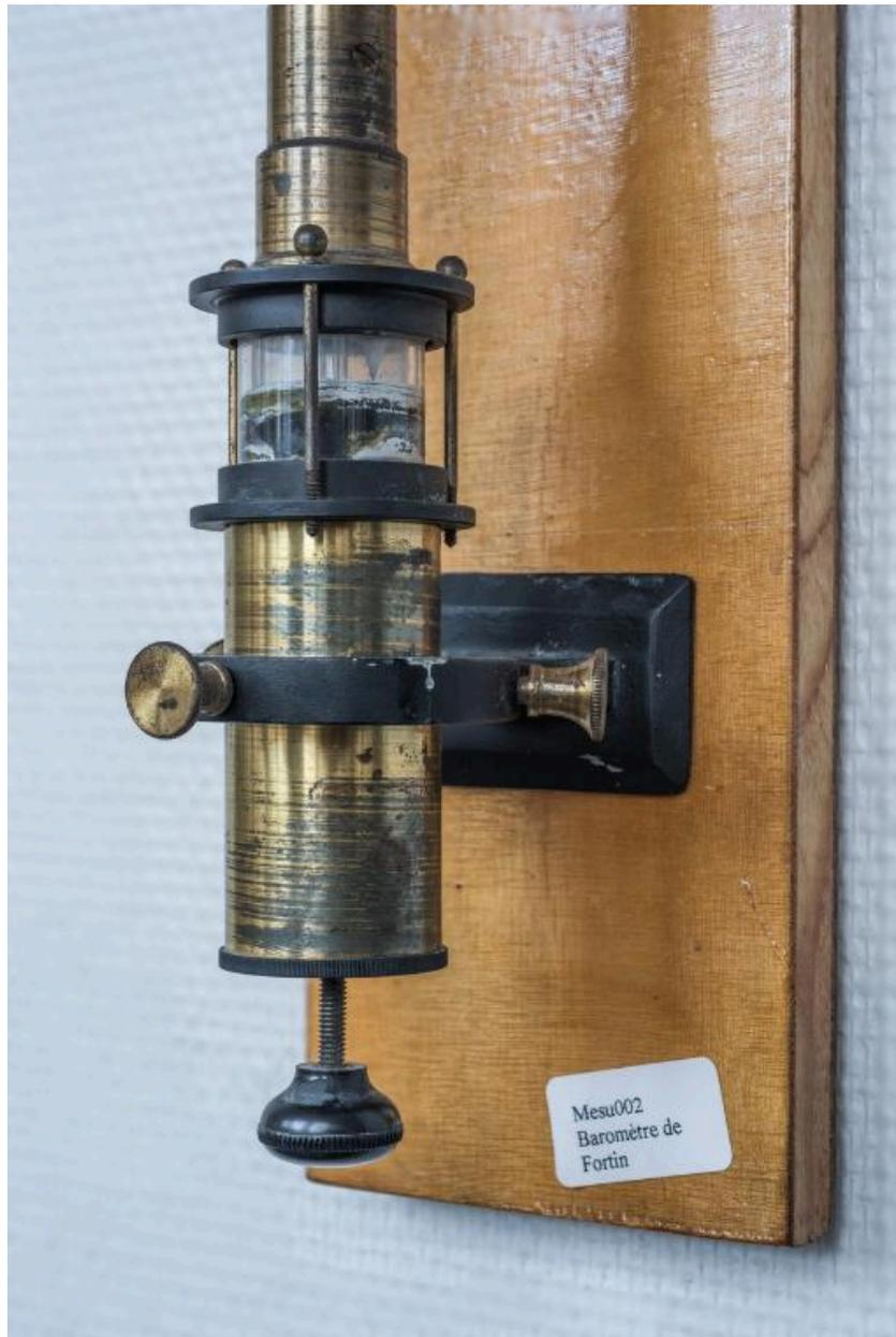
Le fond souple de la cuve du baromètre de Fortin qui permet de régler avec exactitude le niveau du mercure dans la cuvette
