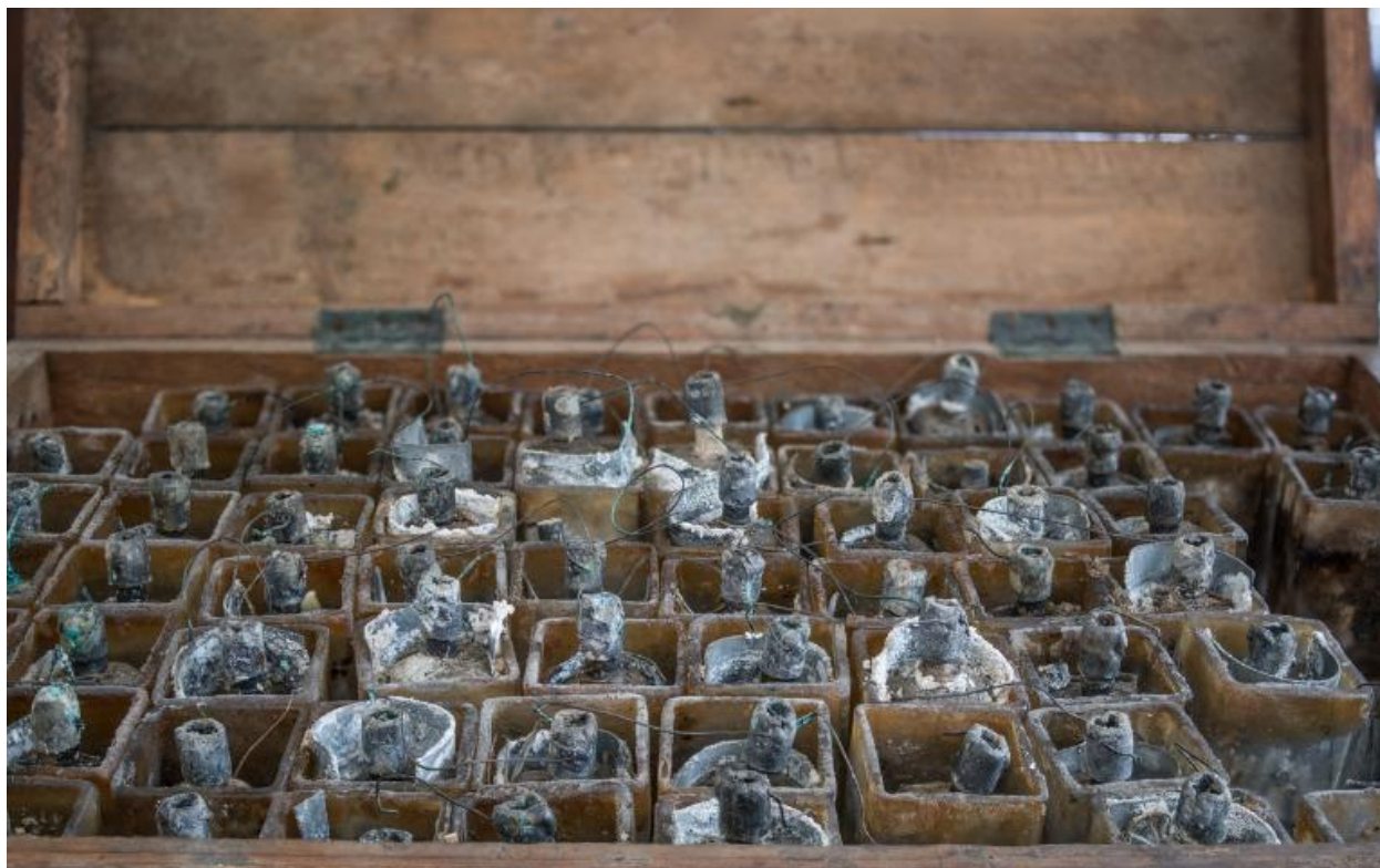
Batterie de piles de Leclanché - Electricité dynamique (Non signé)
